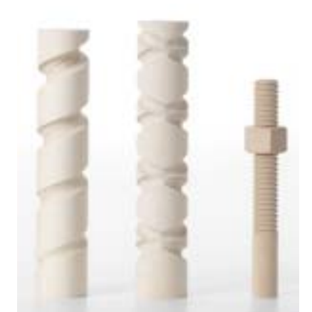
Gewinde schneiden – eine Spezialität der CNC-Drehbank.
